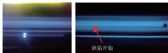
图8 X射线检测结果
