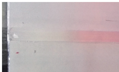
b) SSFSW焊缝（未处理）
